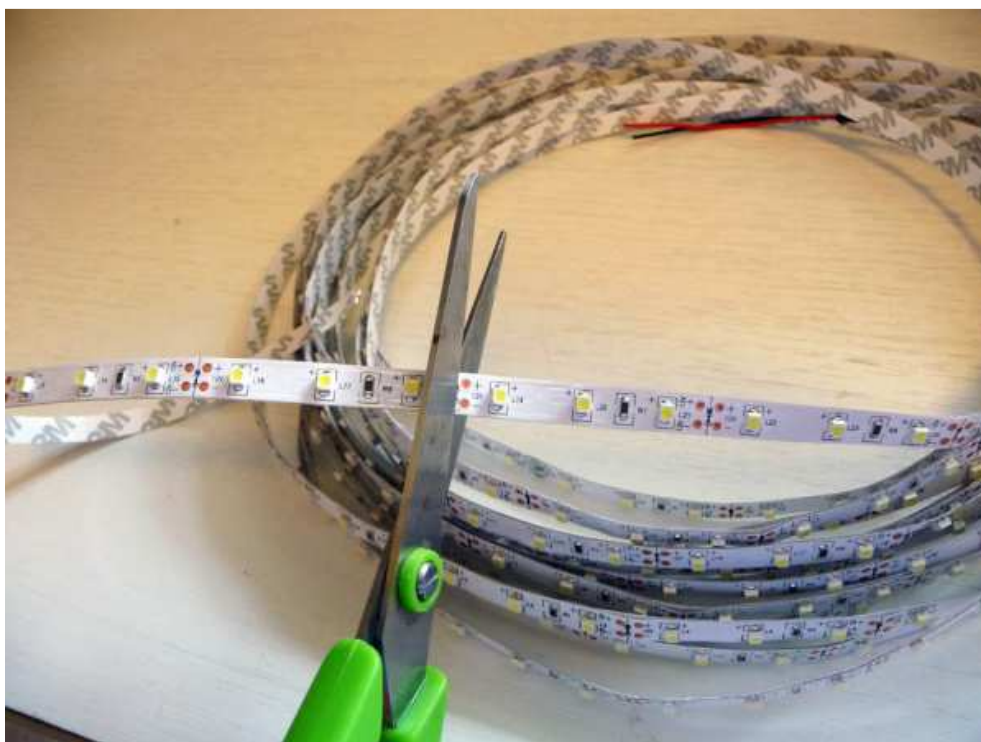
Obr. 2: Obrázek ukazuje jak jednoduché je ustříhnout LED pásek. Bez problémů je k tomu možné použít i obyčejné kancelářské nůžky.
